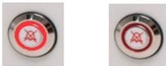
Figura 15.1 Botão de alarme que indica a condição de alarme
