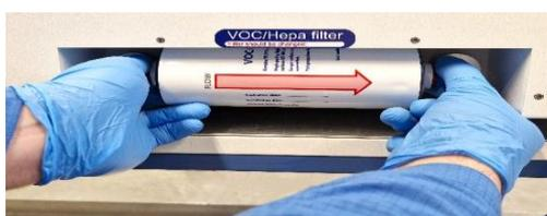
Figura 12.2 Procedimento de inserção e remoção do filtro COV/HEPA
