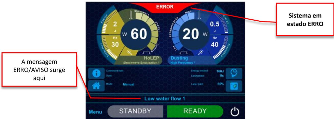
Figura 5.1: Exemplo de ERRO estado - "Baixo nível água 1".
