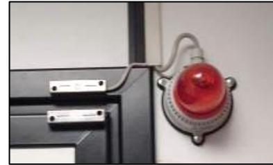
Antes de usar, por favor controlar se o cabo de interbloqueio remoto da porta que está ligado ao microinterruptor instalado na porta está conectado ao painel traseiro da unidade laser. Tal como mostrado na figura, deve ser montada uma lâmpada na entrada o local de trabalho, na estrutura da porta. A lâmpada se deve acender quando o laser está aceso e a porta de entrada para a área de trabalho está fechada.
