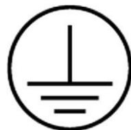
Terra de proteção; aterramento de proteção
