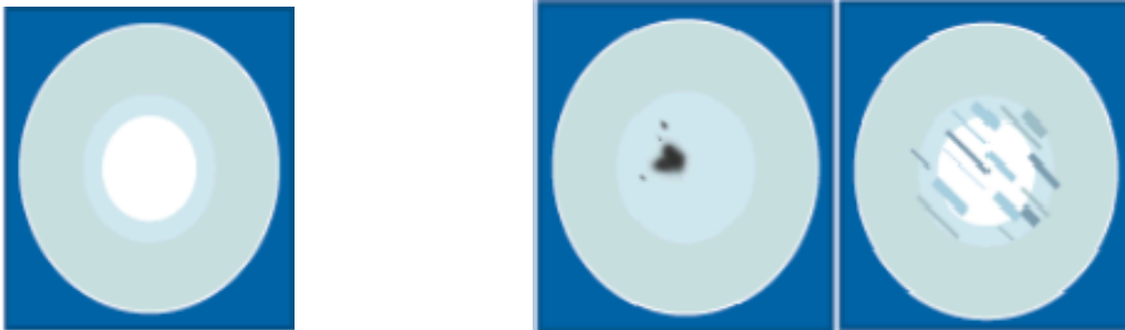
Da esquerda para a direita (conforme visto em um microscópio de inspeção): Fibra utilizável limpa, fibras com evidência de chamuscamento, fibra com riscos.
