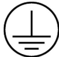
Terra de proteção; aterramento de proteção
