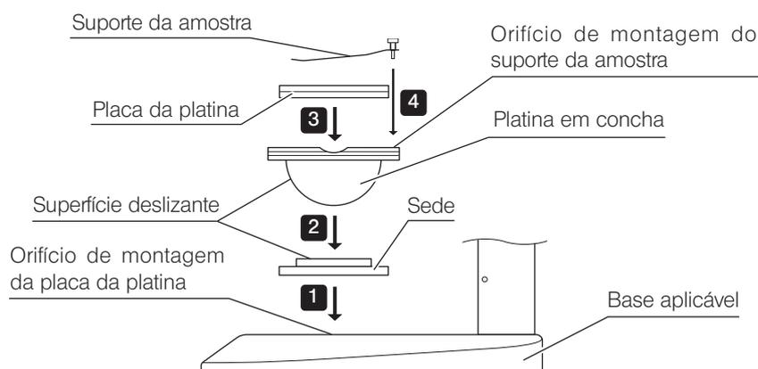
1. Coloque a sede da platina em concha no orifício de montagem da placa da platina de uma base aplicável.
