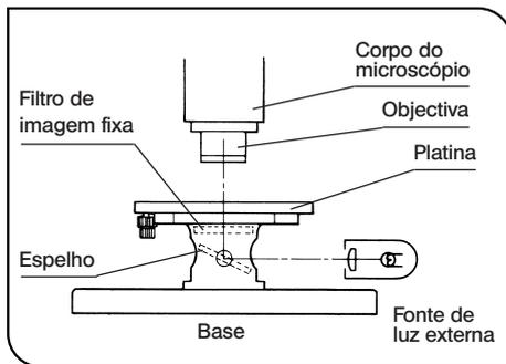
1. Ilumine a amostra com uma fonte de luz externa (iluminador LSD, iluminador com guia de luz, etc.).
