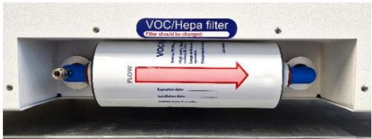
Figura 12.3 Filtro VOC/HEPA instalado corretamente
