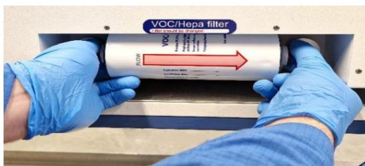
Figura 12.2 Procedimento de inserção e remoção do filtro VOC/HEPA
