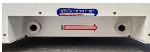
Figura 12.1 A seta de fluxo na incubadora de fertilização in vitro multicâmara MIRI® II-12
