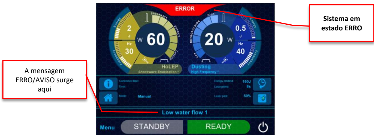
Figura 5.1: Exemplo de ERRO estado - "Baixo nível água 1".
