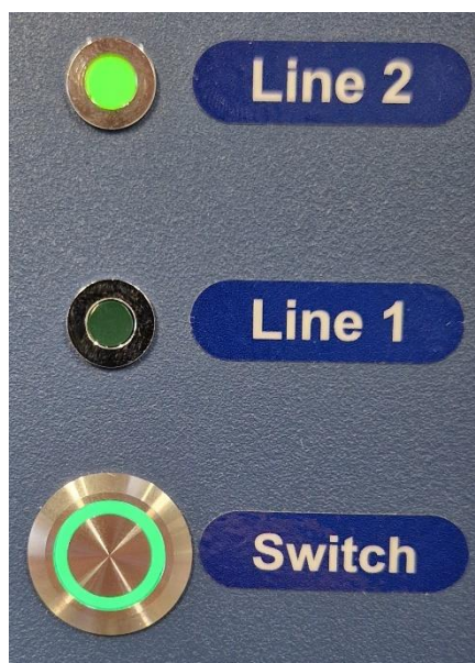
Figura 20.4 O interruptor de alteração de linha da incubadora FIV multicâmara MIRI® TL12 e uma Linha 1 ativa
