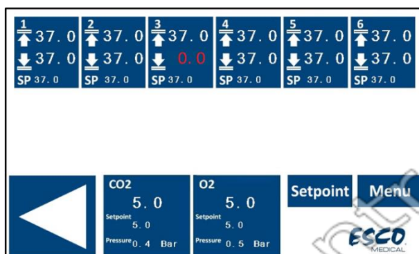
Figura 14.4 Vista de avaria do sensor de temperatura no ecrã principal da incubadora FIV multicâmara MIRI® TL6
