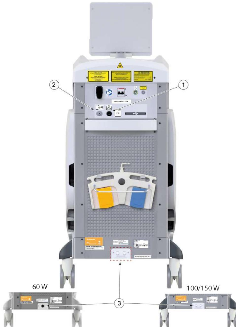
Conexões para o procedimento de enchimento/esvaziamento de água dos sistemas. Na figura, o painel traseiro do modelo de 60W é mostrado no lado esquerdo, enquanto o dos modelos de 100W e 150W é mostrado no lado direito.
