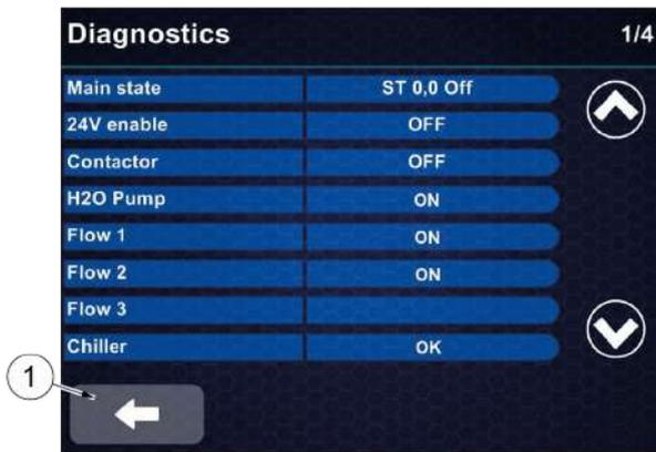
Nesta tela, é possível verificar o nível de água, o status do chiller e ligar a bomba de água (bomba H2O) durante o enchimento do sistema hidráulico na primeira instalação (consulte 7.3.1 Enchimento do sistema hidráulico pág. 64).
